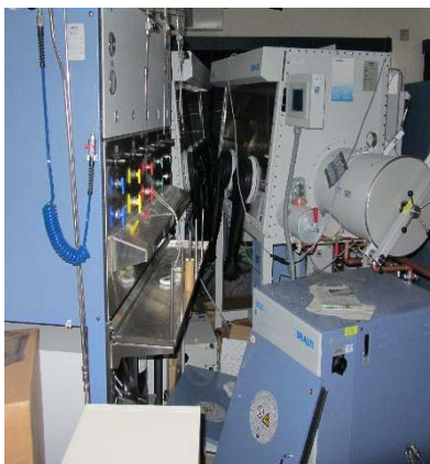
重い実験器具が移動した例。人がいたら確実に挟まれる。
